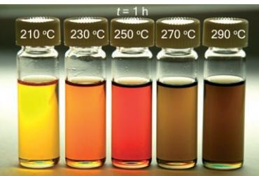
**Her mit den kleinen InP-Partikeln!** Eine Coreduktion liefert InP-Nanokristallkolloide hoher Qualität. Die Synthese nutzt  $\text{PCl}_3$  als Phosphorquelle und Superhydrid als Reduktionsmittel. Mit HF angeätzte nicht vorbehandelte Nanokristalle zeigen
